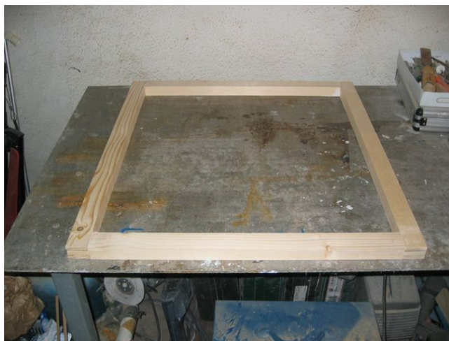
Illustration 4: Cadre porteur (dimension extérieures 60 X 65 cm et 4 cm de large)
