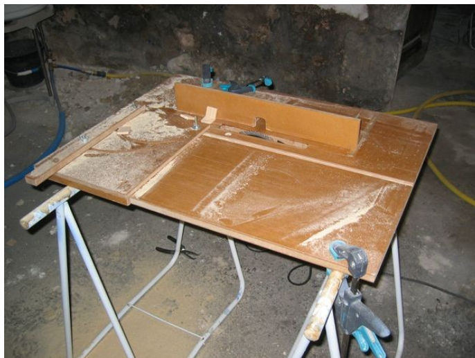
Illustration 3: La table supportant la scie circulaire avec une règle ajustable
